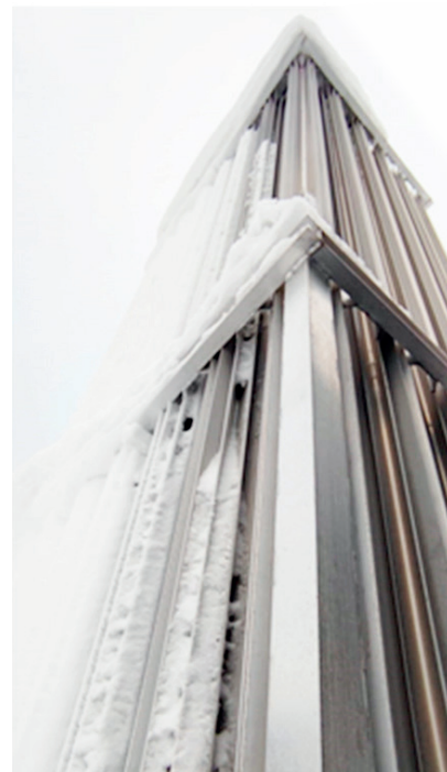
Рис. 10. Атмосферный испаритель высокого давления производства ООО «Мониторинг Вентиль и Фитинг»
