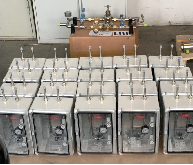
Рис. 4. Контрольно-отключающие коробки и газовый щит MV&F с регуляторами давления RegO перед отправкой в больницу, май 2020 г.
