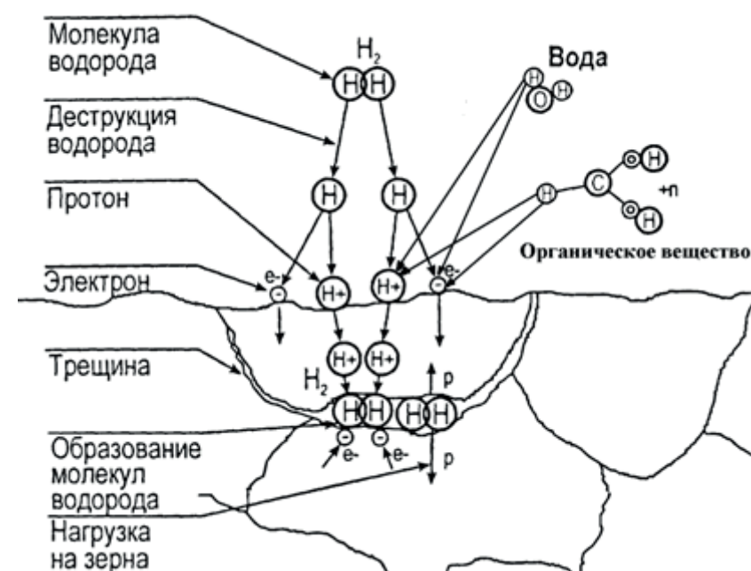
Рис. 8. Механизм водородного охрупчивания
