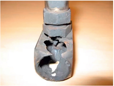
Рис. 6. Результат теплового воздействия на арматуру от возгорания при наличии в системе крупных механических примесей
